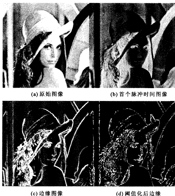
图4 脉冲神经网络的边缘检测
