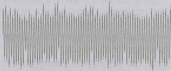
图4 RSA 密码算法原始功耗曲线细节
