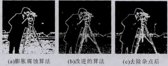
图 5 膨胀腐蚀算法和改进的膨胀腐蚀算法检测结果
