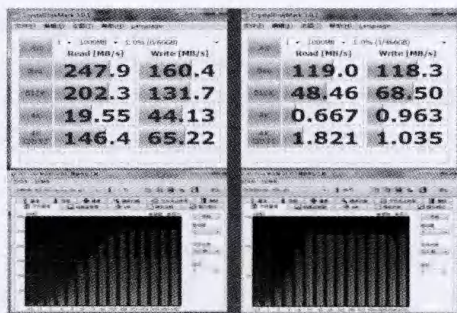
图 9 机械硬盘及 SSD 加解密测试结果(左为 SSD)
