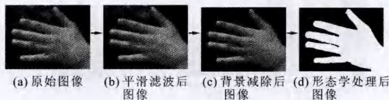
图 8 PE 阵列对原始图像进行平滑滤波、背景减除、形态学处理之后的效果图
