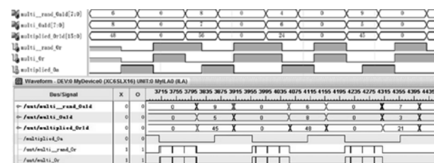
图5 FPGA 中的功能仿真波形及板级波形
