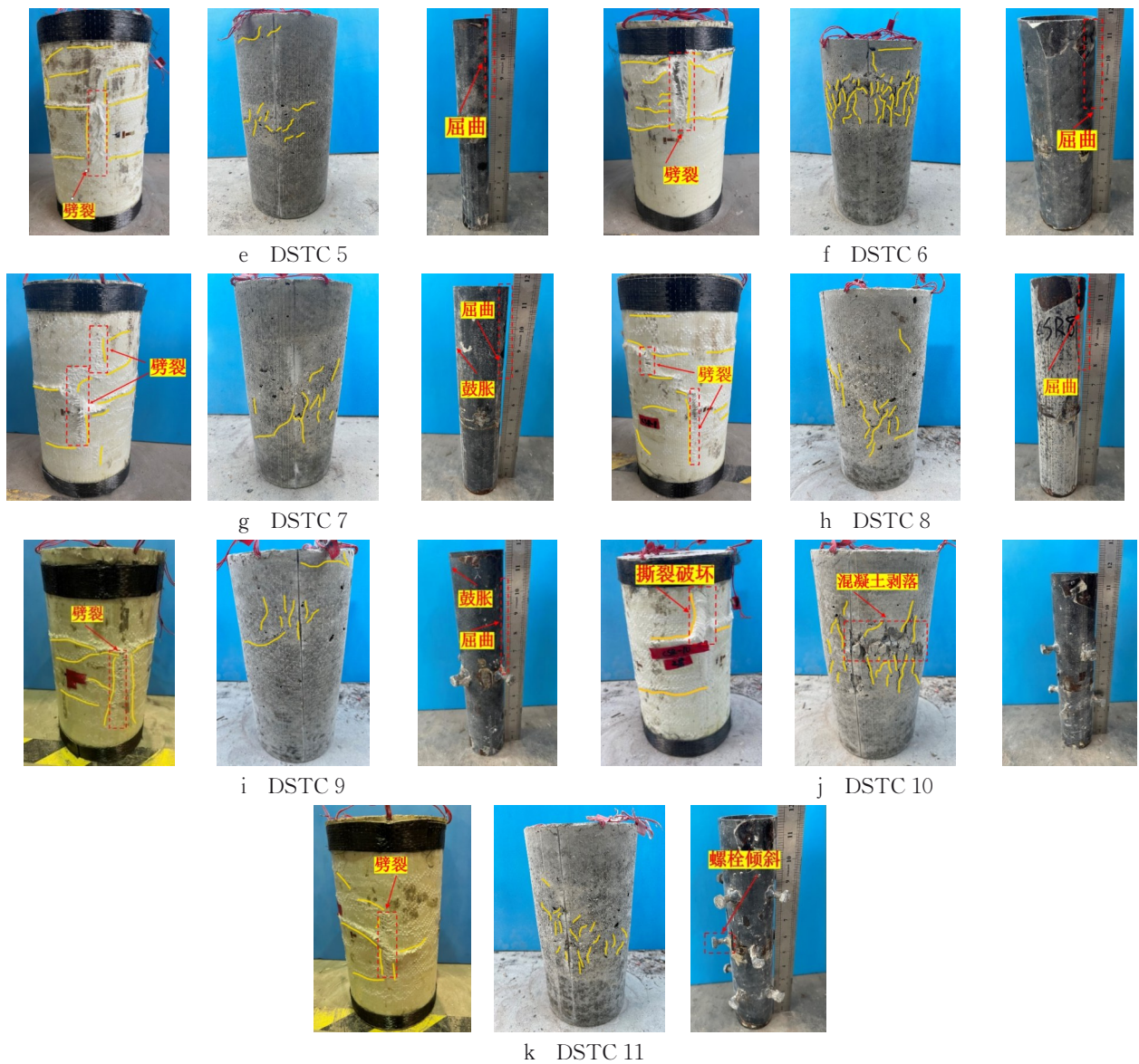
图4 DSTC试件轴压破坏形态图
