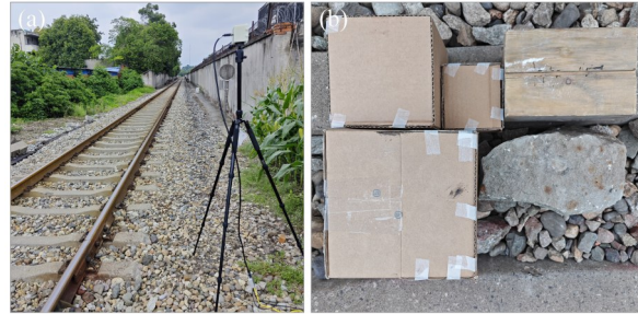
图6 实验场景布置与障碍物实物图。(a)激光雷达安装场景;(b)障碍物细节
