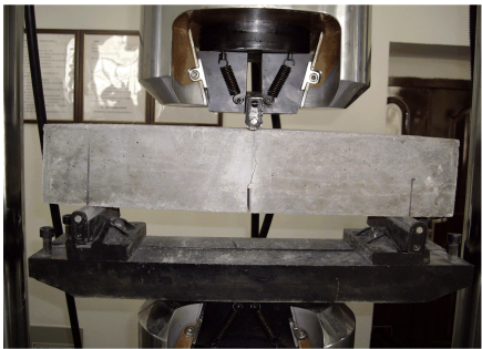
图 2 试件与实验机压头局部示意图
