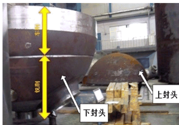
图2 水室封车削及铣削部分
