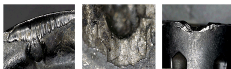
a) 月牙洼磨损 b) 裂纹 c) 崩碎
