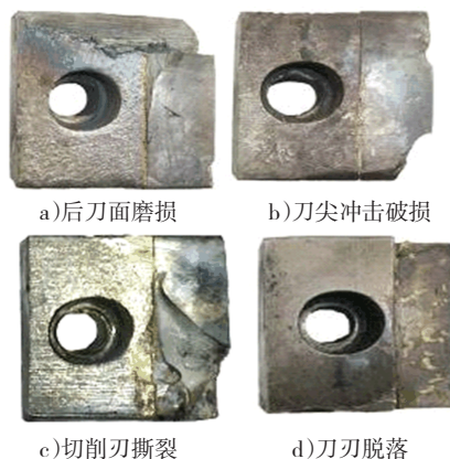
图10 重型焊接车刀主要失效形式
