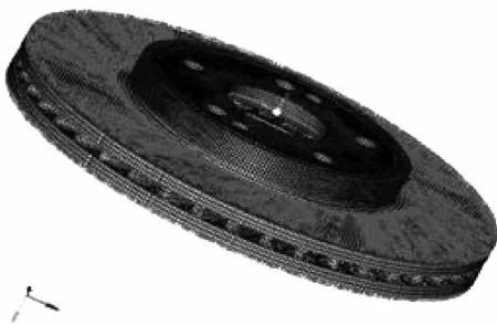
图 6 基于 HyperMorph 盘式制动盘形状预定义
