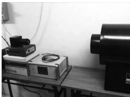
图2 黑体炉标定实验装置图
