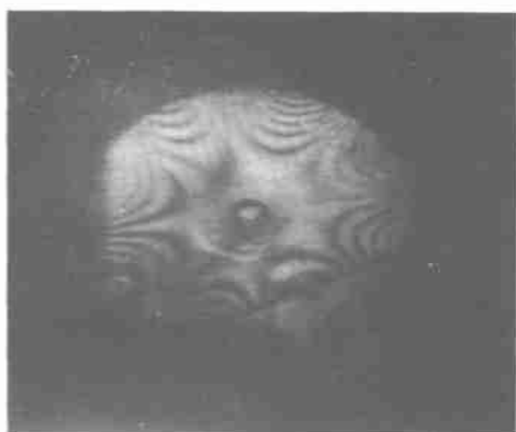
图 2 振型全息图 (a 为 4 节径静态 f = 1174 \text{ Hz} ; b 为动态 n = 2208 , f = 1324 \text{ Hz} )
