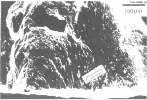
图4 试样表面的氧化物 ([001]取向, 980°C, \Delta\epsilon/2=1.0\% ) Fig 4 Oxide on the specimen surface
