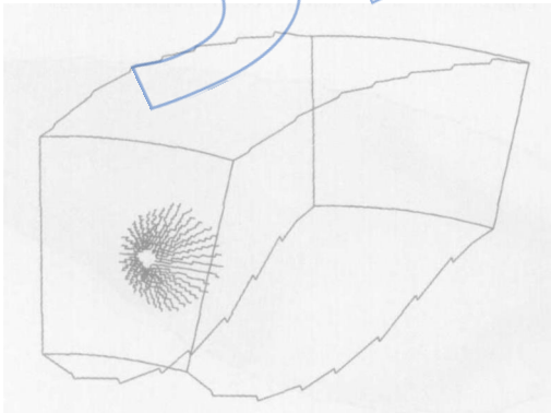
图 6 同一直径不同位置的油珠轨迹 Fig. 6 Droplet trajectories of different ejecting fuel positions with the same diameter
