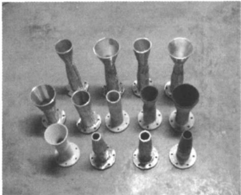
图 1 PDE 尾喷管试验件实物照片
