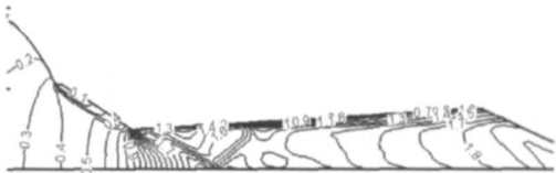
图 10 领结形的 SCFN 流场在 XZ 对称面上的 Ma 等值线图
