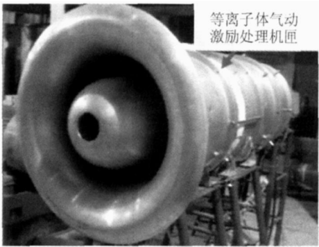
图 4 安装等离子体气动激励处理机匣的实验台
