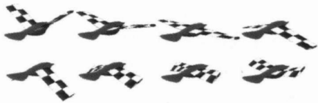
图 1 扑翼柔性变形示意图
