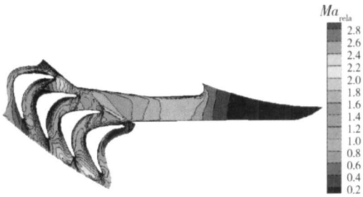
图 4 原型涡轮中径截面相对马赫数分布 Fig.4 Relative Mach number distribution at half span of the prototype rotor blade
