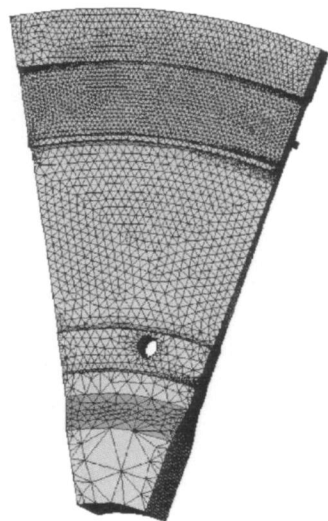
图 1 涡轮盘的三维网格划分
