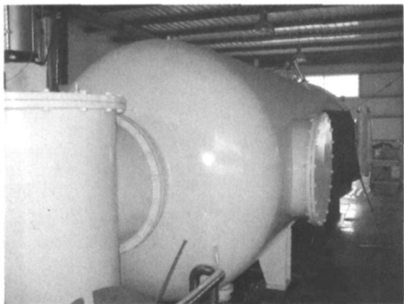
图 1 离子发动机真空实验系统 Fig. 1 Vacuum test system of ion thruster
