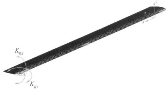
图 4 主桨叶根部边界条件的模拟示意图 Fig.4 Limit on rotor blade
