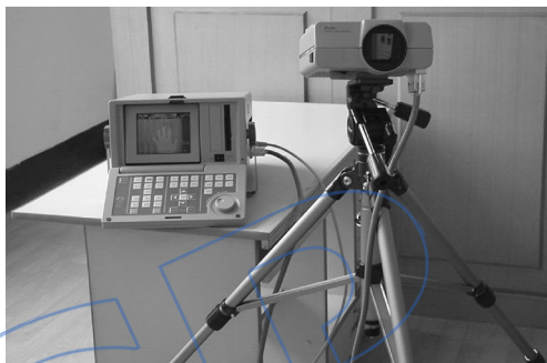
图1 红外热像仪实物图
