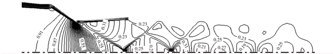
图 4 周期面上喷管附近的无量纲等压力线图( p/p_{\max} )
