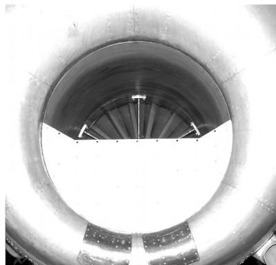
图 2 扰流板在吊舱内安装图
