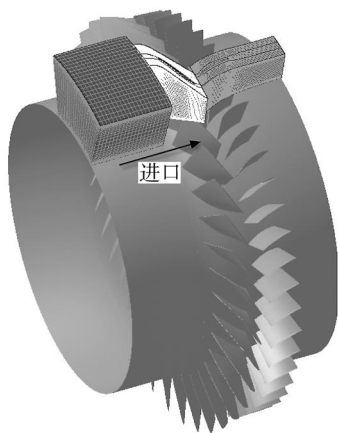
图 1 单通道计算网格 G1 Fig. 1 Computation grid G1 of single passage
