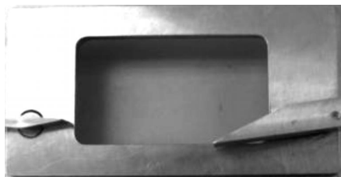
图 3 涡发生器和楔块安装实物图
