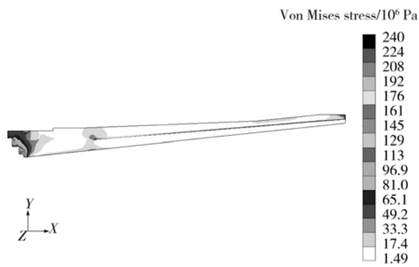
图 9 扩张段内外层壳体的 Von Mises 应力
