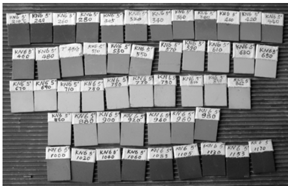
图 2 标准样片的示温漆变色图
