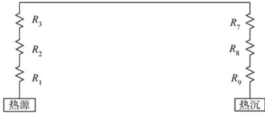
图4 平板热管简化热阻分布示意图
