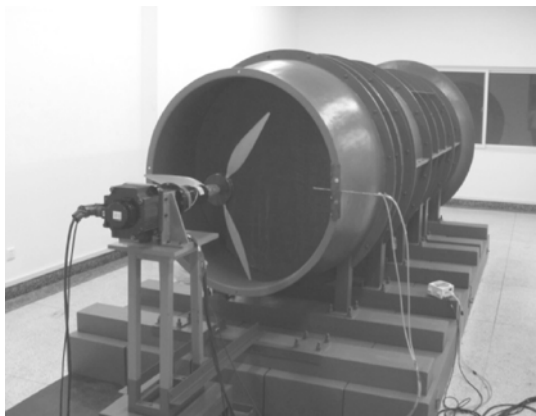
图2 平流层飞艇螺旋桨地面试验风洞
