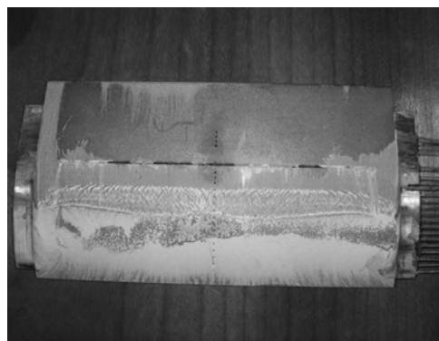
图5 吸力面油流试验结果 ( Ma_1 = 1.27, \beta_1 = 29.5^\circ )
