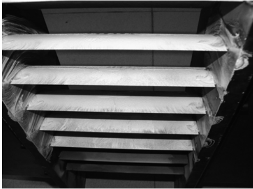
图6 试验件油流试验结果
