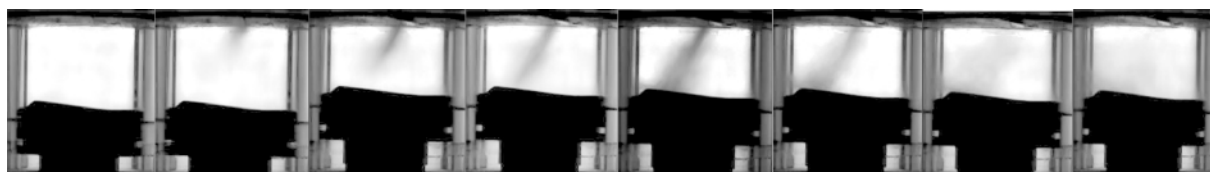
(a) 转速200 r/min, 燃油喷射时刻90°CA ATDC缸内混合气形成过程
