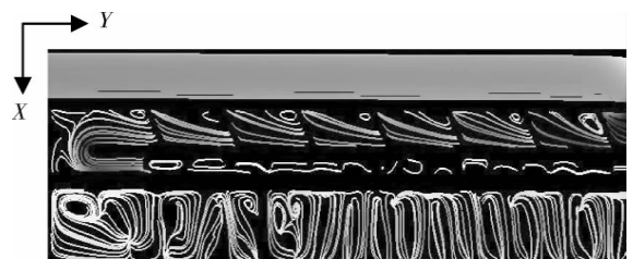
图 5 距离压力面 0.7 倍肋高处截面 流线图 ( Re=31724 )
