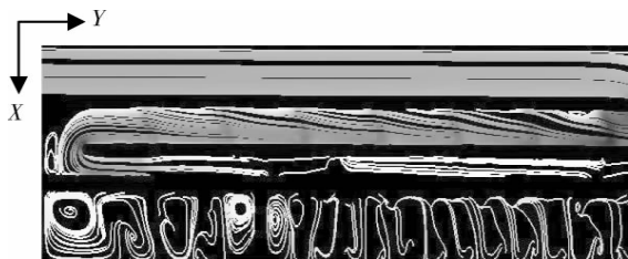
图6 距离压力面1.5倍肋高处截面 流线图( Re=31724 )
