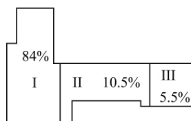
图 2 FGH96 全尺寸盘缺陷位置分布
