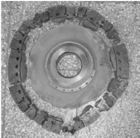
图 8 破裂全貌 Fig. 8 Burst appearance
