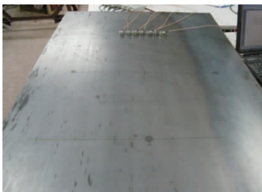
图 5 测试钢板及传感器布置
