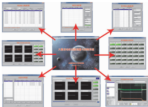
图 5 测控系统软件主要模块前面板
