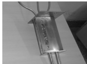
图8 一体化设计的整流支板火焰稳定器
