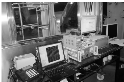
图 3 电控旋翼测控系统
