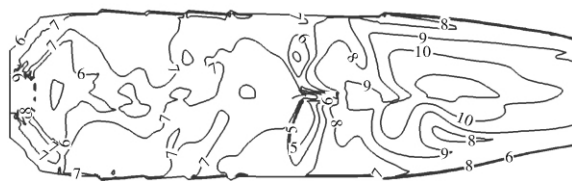
图 2 K=35 截面轴向速度等值线 (工况 I)
