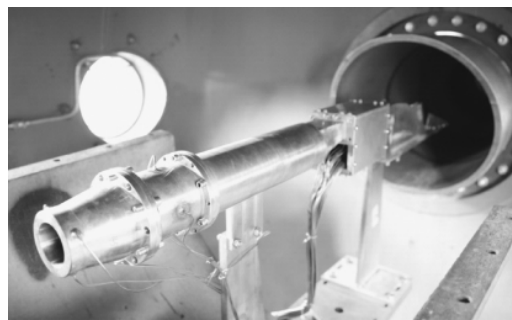
图 7 进气道试验模型的风洞安装
