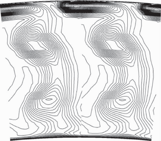
图 25 1 级动叶出口相对总压云图
