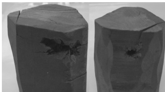
图4 推进剂药柱枪击试验件
