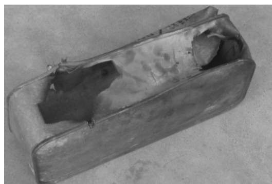
图7 发动机模拟试验中破坏的铁箱
