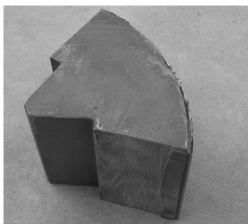
图5 贮存18年的发动机壳体/衬层/推进剂组合件
