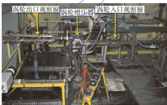
图 5 美国空军实验室 PDTE 照片 Fig. 5 Photo of PDTE in Air Force Research Laboratory
