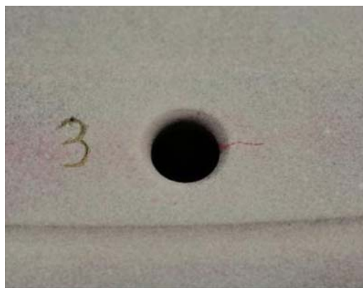
图 2 均压孔裂纹显示形貌
