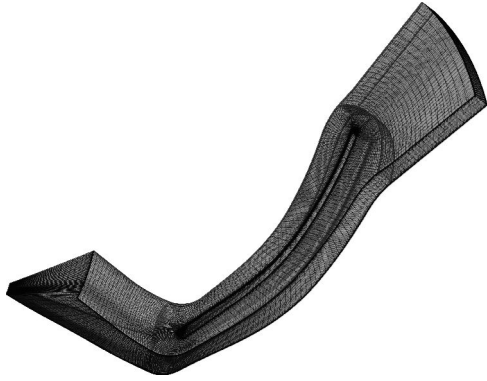
图 6 闭式后弯叶轮计算网格模型
