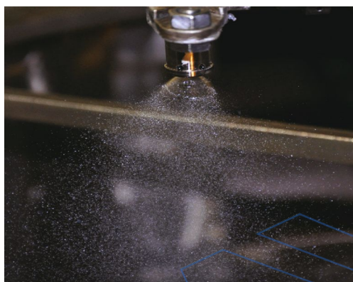
图 7 清洗前喷嘴在相对压力为 0.08 MPa 时的雾化结果
