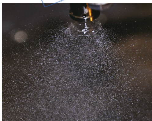
图 8 清洗后喷嘴在相对压力为 0.08 MPa 时的雾化结果
