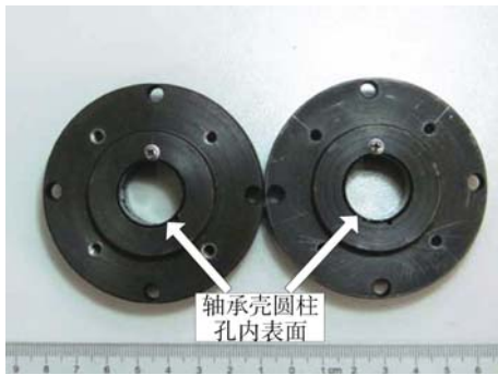
图9 两个不同轴承壳圆柱孔内表面粗糙度的箔片轴承
