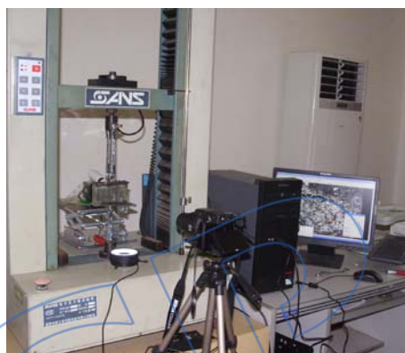
图 2 宏观动态观察试验系统设置
